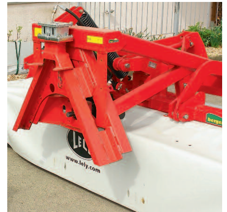
Das Gegenstück ist dem Gerät angepasst. Im Kopfteil befindet sich die Hydraulikaufnahme.
