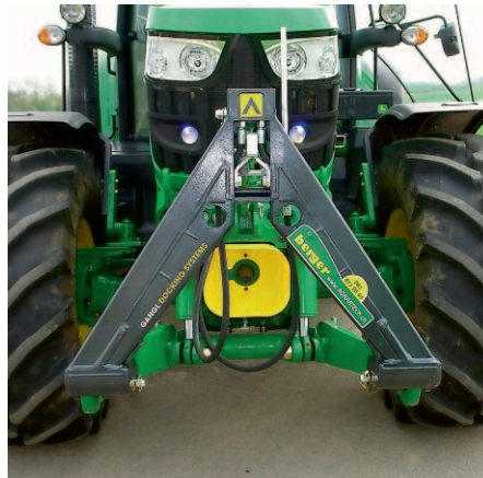
Dieses vereinfachte Kupplungsteil ohne Zapfwelle verbindet im Kopfteil die Hydraulik.
