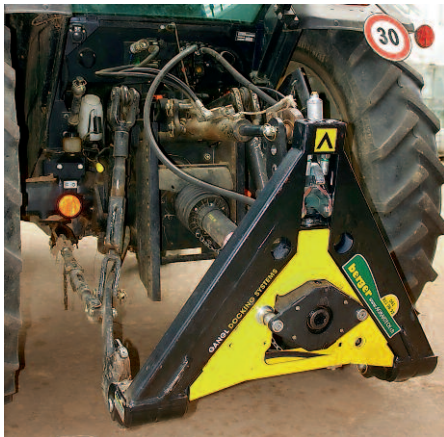
Dieses Kupplungsteil hat ein Zapfwellenmodul, das hydraulisch aufgeschoben wird.
